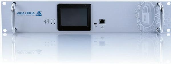
High-End Zutritts-Terminal zum Betrieb an einem Server/ PC mit Betriebssystem Windows Server 2008 / 2012 / 2016 / 2019, Windows 8 / 10
